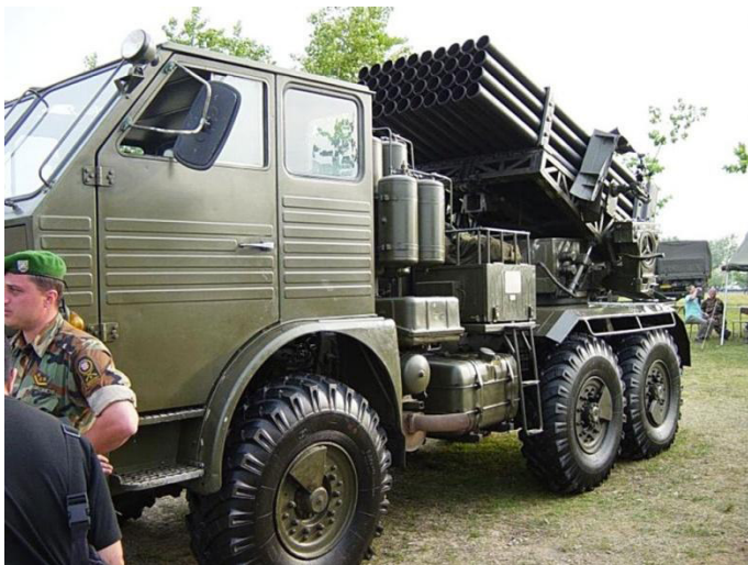
ФОТО 52. Хорватская сорокоствольная РСЗО APR-40, в которой применялись 128-мм неуправляемые ракеты РСЗО «Огнь»
